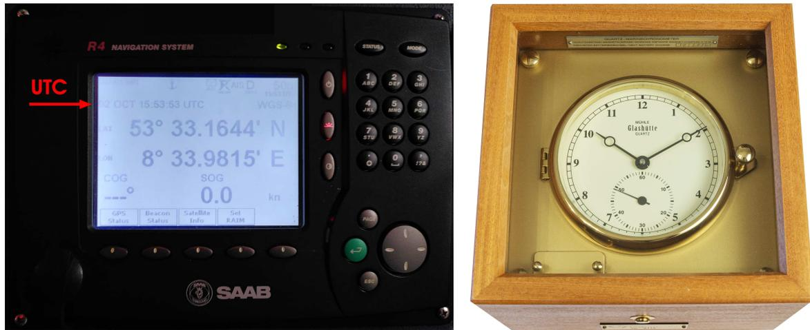
Bild 19: GNSS-Empfänger und MÜHLE-Chronometer (Gangschwankung  $\leq 0,01$  s/Tag bei  $22^\circ\text{C} \pm 1\text{K}$ )
